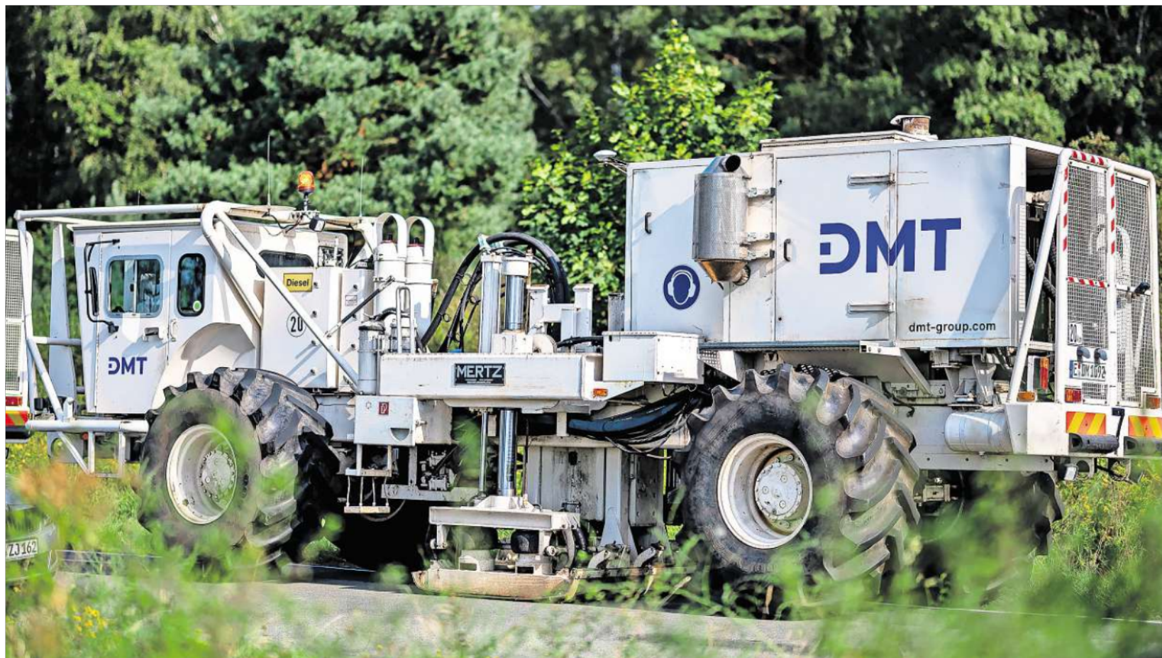
Untersuchen den Untergrund im Osten der Stadt: die gut 20 Tonne schweren Vibrotrucks des Ingenieursdienstleisters DMT.
